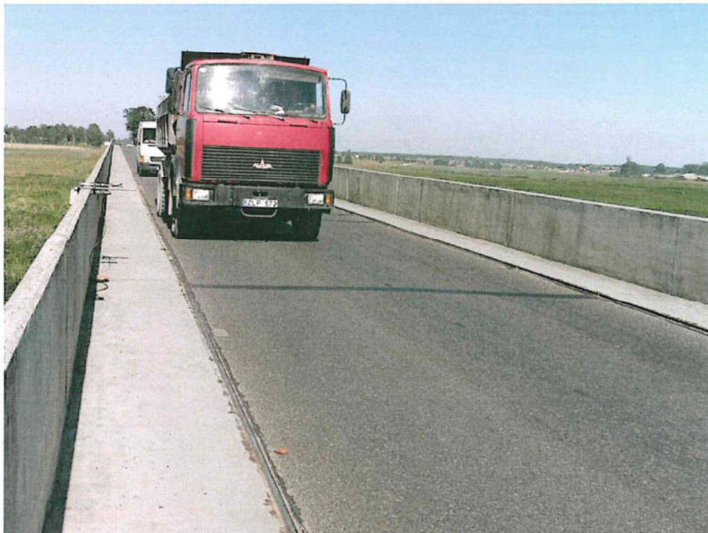
1.9.1 pav. Dinaminio bandymo nuo natūralaus eismo metu tiltu važiuojanti sunkiasvorė transporto priemonė
